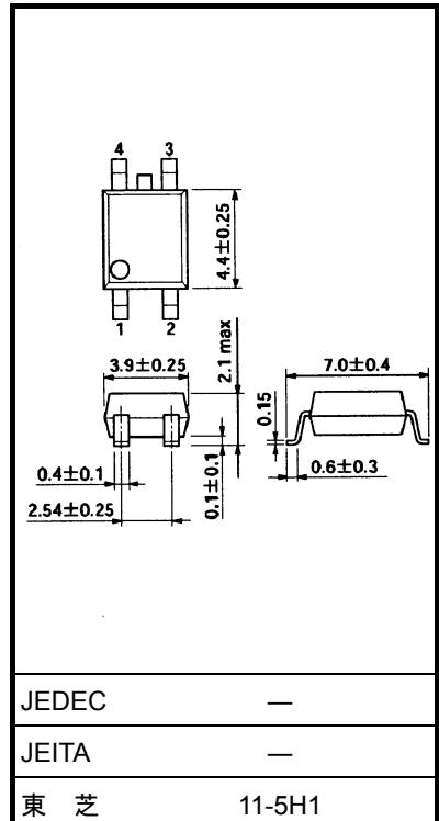
TLP170G は、フォト MOS FET と赤外発光ダイオードを光結合させた、2.54 mm ピッチの 2.54 SOP4 ピンパッケージ (4 ピン、高さ 2.1 mm) のフォトリレーです。
