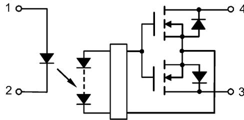
図 5.1 内部回路構成
