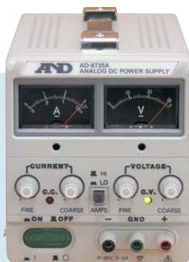
トラッキング動作が可能・・・2台を並列接続した場合、直流30V、6Aの電源として、直列接続した場合には直流60V、3Aの電源として使うことができます。
