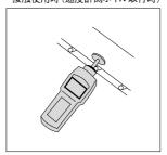
付属の速度計測ホイルを取付け、 速度・長さを計測します。
