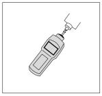
被測定物の回転中心に接触子 を当て、計測します。※1
