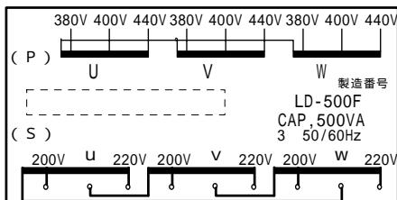
出荷時の2次(S)側ショートバーは相記号(u.v.w)端子と200V端子間に設定しております。相記号(u.v.w)端子へ負荷を接続しご使用下さい。
