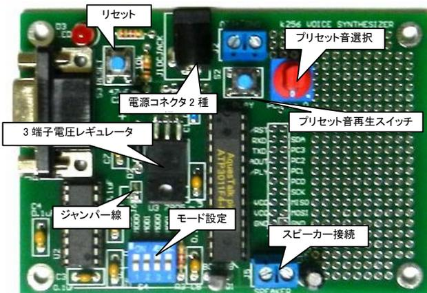
**組み立て:(重要)電源の供給方法によりますがジャンパー線のハンダ付けが一箇所必要です。後述)**
