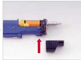
ノズルリムーバーをノズルカートリッジに差し込みます
