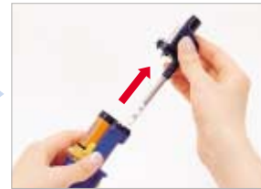
ノズルを引き抜き、交換します
