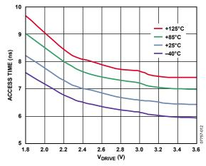
Figure 12. Access Time vs. VDRIVE
