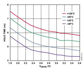
Figure 13. Hold Time vs. VDRIVE
