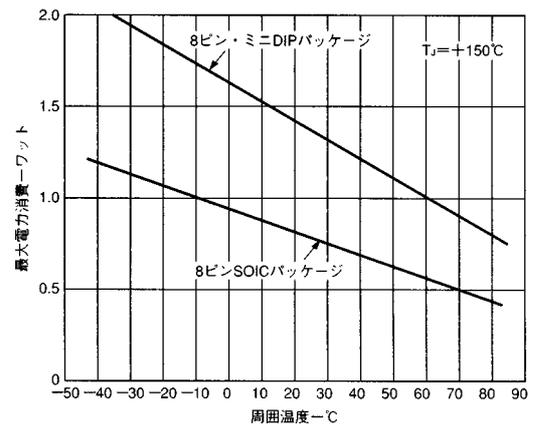
図2. AD8180最大電力消費対温度
