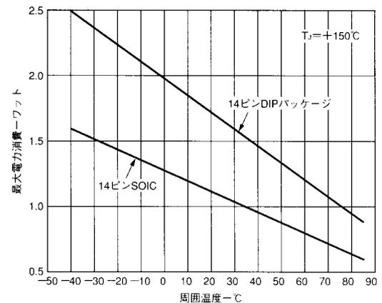
図3. AD8182最大電力消費対温度
