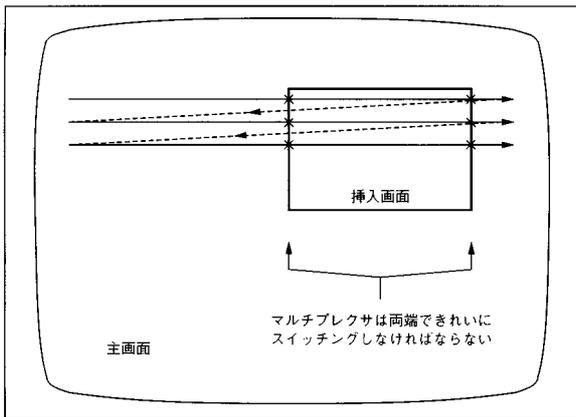
図24 . 「多重画面」ピクセルのスイッチング
