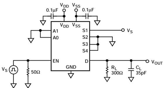
図26. テスト回路6 - イネーブルから出力へのスイッチング遅延
