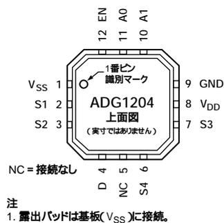
図3. LFCSPのピン配置
