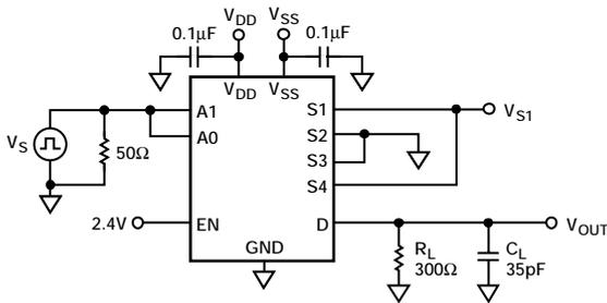
図25. テスト回路5 - ブレーク・ビフォア・メーク遅延時間
