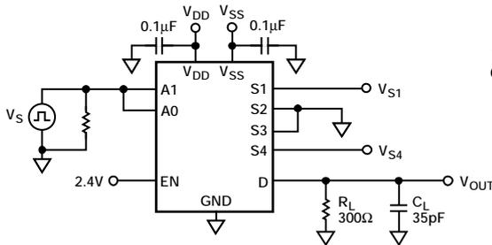
図24. テスト回路4 - アドレスから出力へのスイッチング時間
