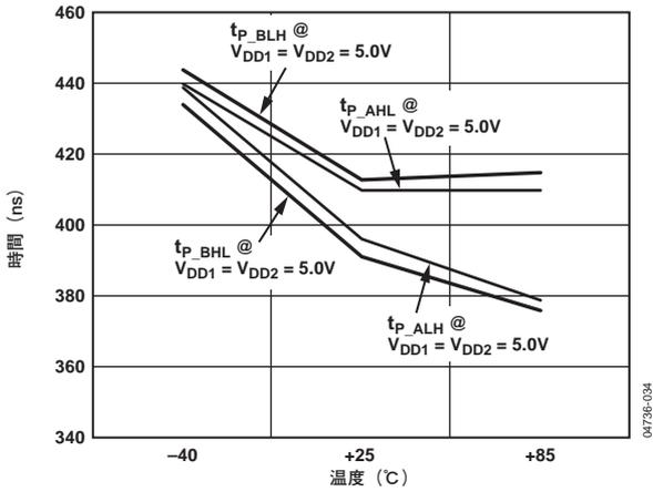
図19. ドライバの伝搬遅延の温度特性
