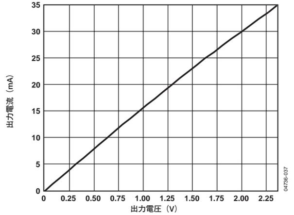
図25. レシーバ出力ローレベル電圧 対 出力電流
