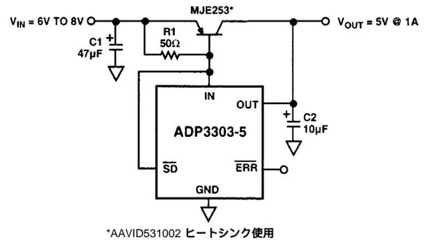
図24 . 高出力電流リニア・レギュレータ
