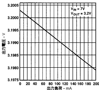
図3. 出力電圧と負荷電流の関係
