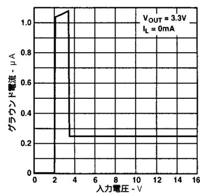
図4. 静止電流と供給電圧の関係
