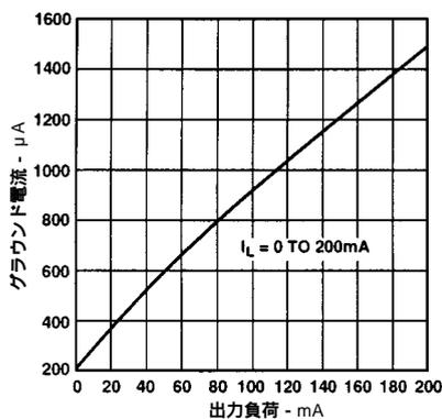
図5. 静止電流と負荷電流の関係
