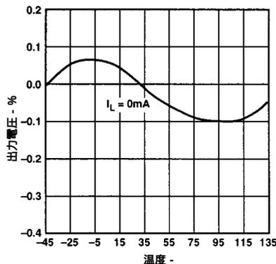
図6. 出力電圧変化率(%)と温度の関係
