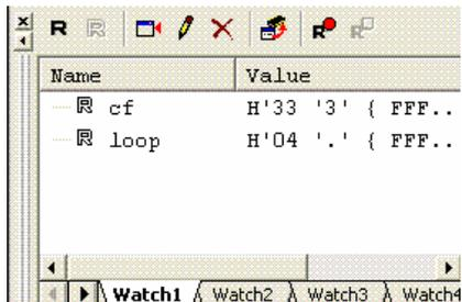
loopは長いのでブレークポイント（茶色のダブルクリックで設定、解除）を設定し、実行。先に進みます。
