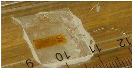
歪センサは金属箔で出来ています。荷重によって金属箔が歪み、抵抗値が変化することを利用して重量等を計測するセンサです。写真のように変化するものに接着剤で貼り付けて使用します。
