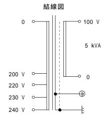
EN規格に適合させる為、トランス外部に保護機器を接続して下さい。
