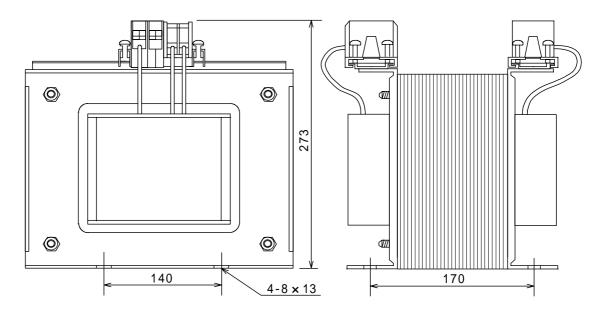
適合規格: EN61558-2-4 1997 (機器用乾式・非短絡耐性トランス、Class 1、IP00) 保護回路:短絡保護及び過負荷保護の為、1次側及び2次側にEN/IEC規格適合の
