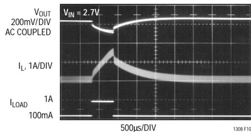
図10. GSM負荷過渡応答。高速掃引速度
