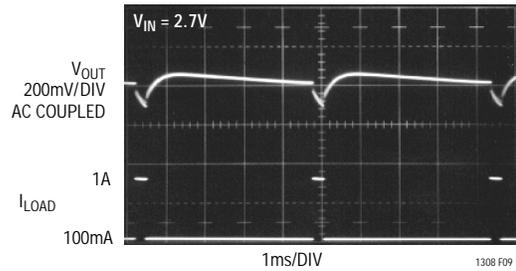
図9. GSM負荷過渡応答。VINが低い場合、
