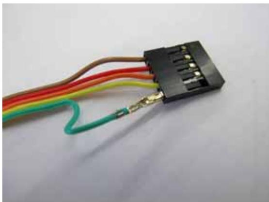
リモコン受光部&USB コネクタ基板の CN3 と、マイコン基板の CN5 をつなぐ配線の完成写真です。次に、マイコン基板 CN3 とそこから伸びる配線を作成します。配線表に従い電線を切り取り、コンタクトピンを圧着します。ハウジングに差し込んで下の写真のように作ります。注意点として、ハウジングに 1 番ピンの△マークがありますが、それは無視してください。基板上の 1 番ピンを基準にしてください。
