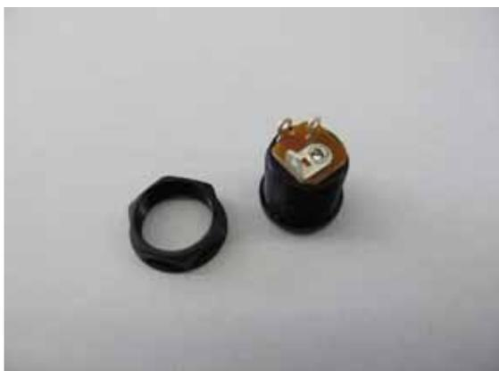
取り付けた写真です。ナットは、樹脂製のため締めすぎると割れてしまいますから注意してください。背面の端子が 3 極あります。
