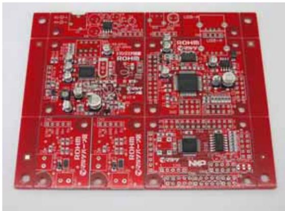
上の写真は、トランジスタ技術 2011 年 10 月号特集で頒布される TDAS-01<トラ技デジタル・オーディオ・ステーション基板です。ローム株式会社様と NXP セミコンダクターズジャパン株式会社様、弊社が協賛して実現した非常にコストパフォーマンスの高い学習基板です。キーパーツとなっている半導体だけでもそこそこ良いお値段がします。この超お買得体験基板の内容についてですが、基板に搭載された IC の機能はトラ技 10 月号にも紹介されているので省略しますが、この基板全体で、USB メモリーに記録された音楽データをデコードして、音声信号を増幅してスピーカー、ヘッドホン、そして、FM 電波で飛ばす機能を実現できます。そしてその操作は、赤外線ワイヤレスリモコンでおこないます。
