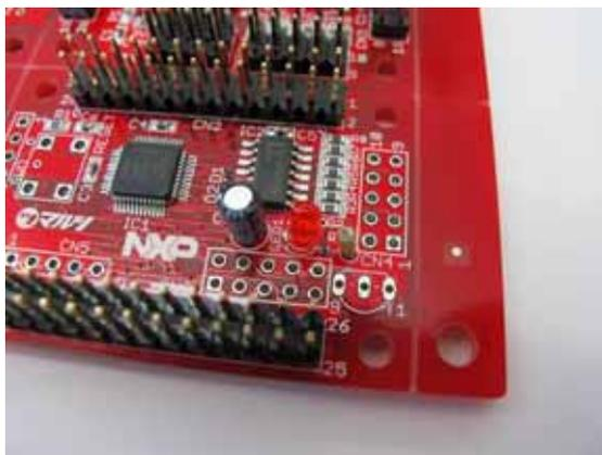
トランジスタ T1 を取り付けます。トランジスタの形状と、シルクの形状を合わせて取り付けてください。
