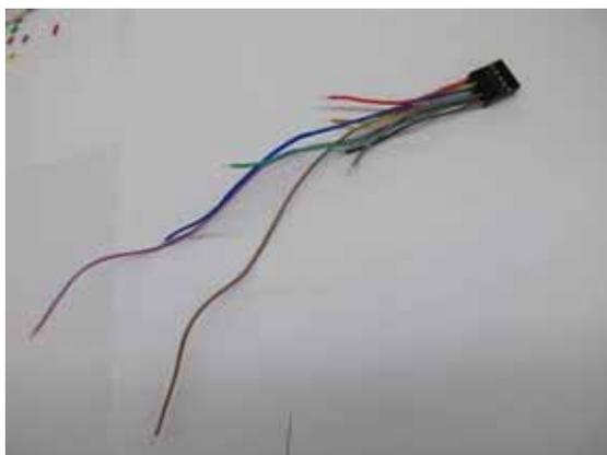
反対側にもコンタクトピンを取り付けます。あと順次、配線表、配線図を参考に配線を組み立てていきます。一通りの配線が完成すると、下の写真のようになります。
