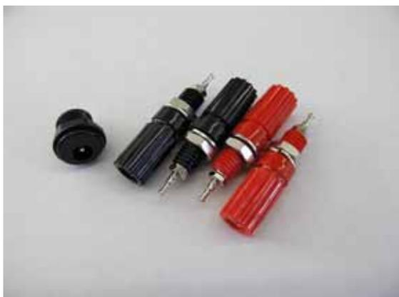
リアパネルにスピーカーターミナルを取り付けます。対辺 10mm のナットとワッシャを取り外してパネル全面より差込み、そしてワッシャとナットで固定します。
