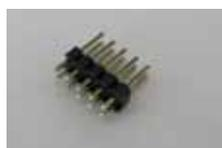
CN1、CN2、CN3 にピンヘッドを取り付けます。この部品には、抜け止めが無いので、裏返しにしてはんだ付しようとする、部品が抜け落ちてしまいます。そこで、アイデア！
