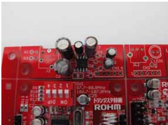
積層セラミックコンデンサを取り付けます。極性はありませんが、後で、チェックしやすいように容量表記の面を見やすい面に向けて取り付けることをお勧めします。
