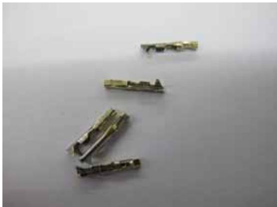
圧着ペンチといっても様々な種類がありますが、ここではオープンバレルタイプ対応のエンジニア製 PA-09 を使用します。このペンチは、試作エンジニアから、評判の良いコストパフォーマンスの優れた製品です。純正とはちがい、歯合せは使用者が勘所で行う事になります。AWG28 のフラットケーブルは、導体線は 1.4mm、被覆部分は 1.6mm で行なうと上手くいきます。
