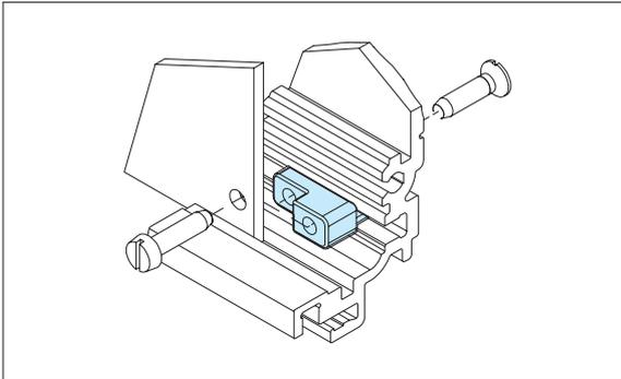
●プラグインユニット/カセットの側面に基板を固定する時にご利用下さい。
