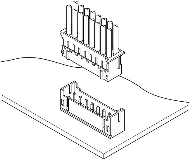
2.0mm ピッチ、圧着タイプ、グリッド (二列) 構造を採用した基板対電線接続用コネクタです。実装高さ 8.8mm、幅 5.0mm のロープロファイル設計で機器の小型化、高密度実装化の要求に対応しました。
