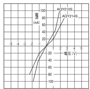
9. 開路時漏れ電流－負荷電圧特性
