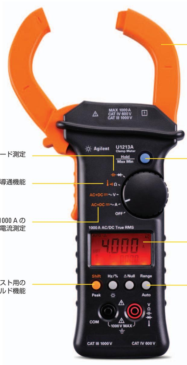
52 mm の大きな顎の開口により、太い電流源をテスト可能
