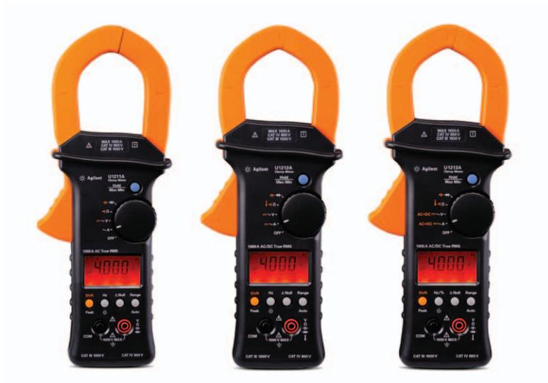
電気配線ケーブルの測定は、危険が伴います。Agilent U1210 シリーズ・ハンドヘルド・クランプ・メータを使用すれば、直径 52 mm までのケーブルに対して、回路を遮断せずに高電流を測定できます。ほとんどのクランプ・メータとは異なり、U1210 シリーズ・ハンドヘルド・クランプ・メータには、抵抗、キャパシタンス、周波数、温度などの DMM 機能もあり、敷設/保守時にトラブルシューティングが簡単に行えます。CAT IV 600V および CAT III 1000 V の安全規格に準拠し、安全に作業が行えます。
