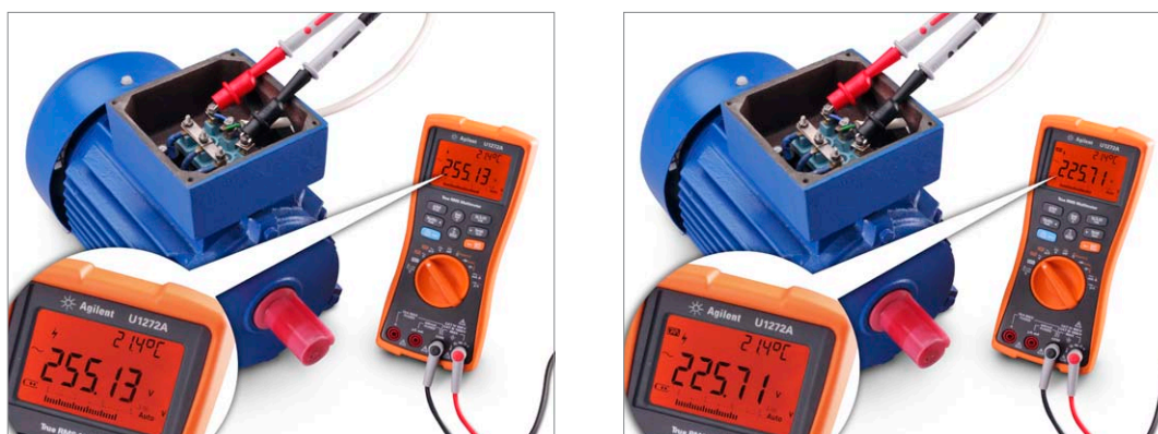
図2：産業用モータVFDからの電圧出力を比較しています（ローパス・フィルタ機能を使用した場合（左）としない場合（右））。
