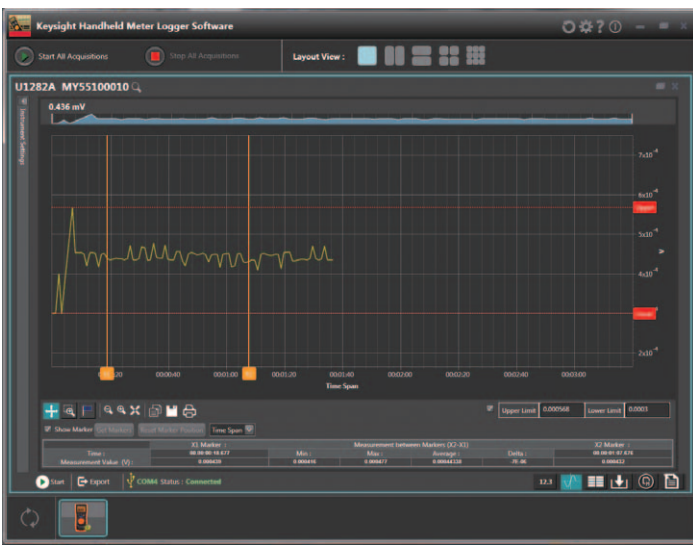
図2. マーカーとリミットレベルが表示されているU1282Aのデータ・ログ・トレンド・プロット。
