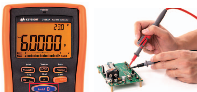
図5. [Hold & Export]ボタン：1回押すと、次の3つの処理が実行されます。測定が実行され、測定値がハンドヘルドDMMのメモリに保存され、赤外線ポート経由で送信されます。オプションのU5404Aリモート・スイッチ・プローブで[Hold & Export]ボタンを起動できます。
