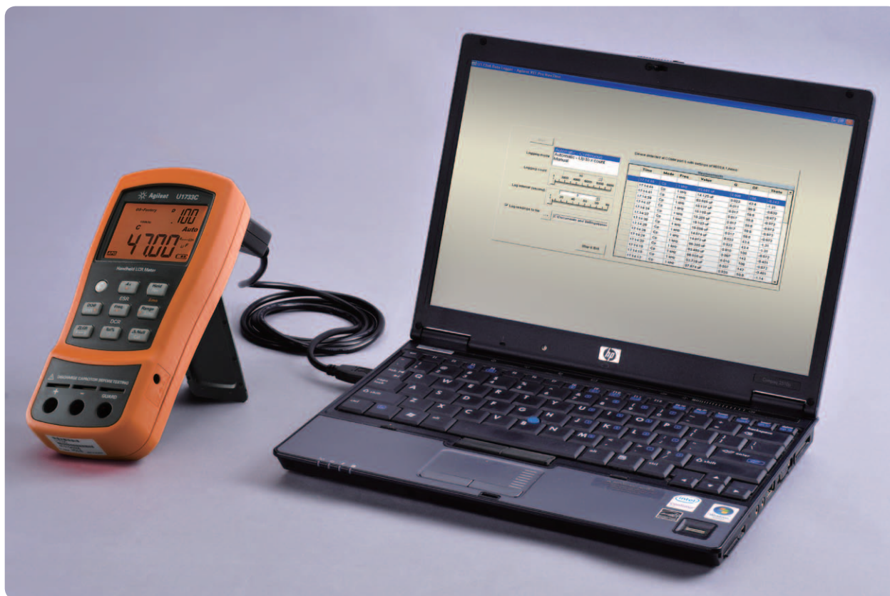
図1. U1731C/U1732C/U1733CをPCに接続すれば、連続した読み値の自動記録が可能
