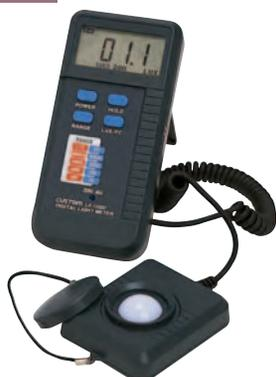
最大200,000Luxまで測定可能。記録計と接続できる出力端子付。
