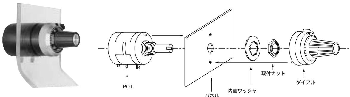
ポテンシオメータを取付ナットと内歯ワッシャとでパネルに固定し、ポテンシオメータのシャフトを左一杯に回してゼロ位置に設定しておき、MGダイアルの目盛を0に合わせた後、MGダイアルのつまみ穴へポテンシオメータのシャ
