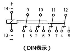
パルス動作(動作モードをインターバルに設定し、下図の結線でご使用ください。)
