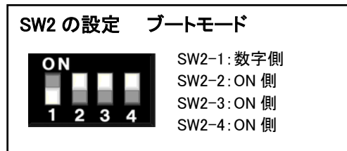
図 5-3 SW2 ジャンパ設定図2
