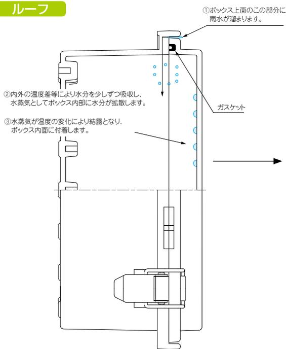
防水樹脂ボックスを屋外に設置する際は製品上面に水溜まりが出来ないように軒下に設置するか、ルーフ等、屋根になるものをつけることをお勧めいたします。(結露の発生を防ぎます。)
