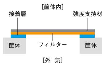
両面テープ接着タイプ（パッチタイプ）は、平面さえあれば場所を選ばず使用可能です。携帯機器の簡易防水として広く使用されています。
