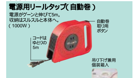
リールタップ(自動巻5m)X(レッド) 10A 125V 合計1,000Wまで コンセント口数:2コ口 耐熱ゴム平形コード2mm 2 、長さ5m使用 コード巻き取り:自動巻き取り方式(プッシュボタン) コード引き出し:手動式
