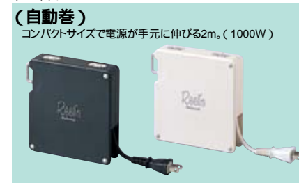
リールタップ(コンパクト自動巻) 10A 125V 合計1,000W コンセント口数:2コ口 耐熱ゴム平形コード1.8mm 2 長さ2m 自動巻き取り方式
