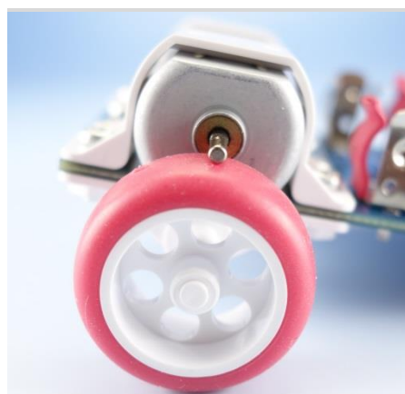
車体を床に置くと、車輪とモーターの軸が接触する仕組みです
