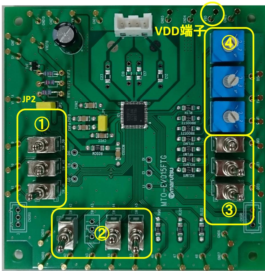
本評価基板には、TB67S289FTGの動作設定を行うための、3点式のトグルスイッチ(左図の①、②、③)、及びAGC機能の調整を行うためのロータリースイッチ(左図の④)を実装しております。使用される場合は、ジャンパーのJP2をショート(初期状態)としていただくか、VDD端子より5V電圧を供給してください。
