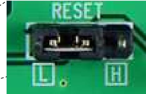
本評価基板には、TB62269FTAGの動作設定を行うための、上図の様なジャンパーを設けております。
