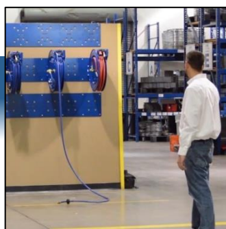
巻取りスピード制御システムにより 緩やかなホース巻取り
