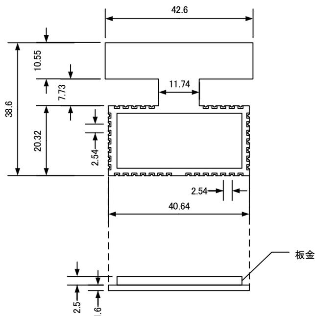
図 1-4. Beetle Module Type K 外形図
