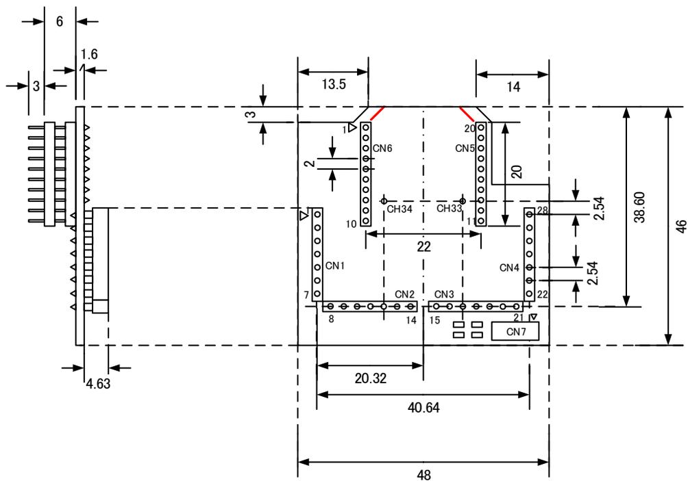
図 1-5. Beetle Module Shield 外形図
