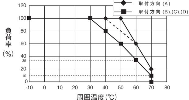
\* 入力電圧範囲"85 VAC ≤ Vin < 90 VAC"にてご使用の場合、出力ディレーティングは破線となります。(取付方向(A)のみ)
