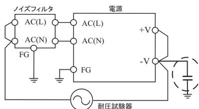
出力-FG間へ コンデンサ容量追加箇所または短絡箇所。尚、+V-FG間でも同じ効果を得られます。
