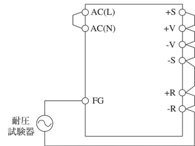
注1) 本機の2次回路筐体間結合は積層セラミックコンデンサが使用されています。
