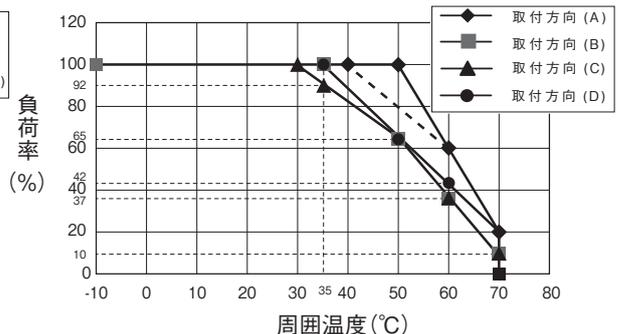
※入力電圧範囲“85 VAC ≤ Vin < 90 VAC”にてご使用の場合、出力ディレーティングは破線となります。(取付方向(A)のみ)
