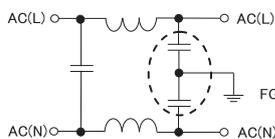
入力-FG間のコンデンサ容量が増加するノイズフィルタの例。
