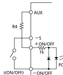
図10-2 ON/OFFコントロール接続方法(B)
