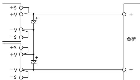
図12-1 出力電圧積み重ね直列運転
