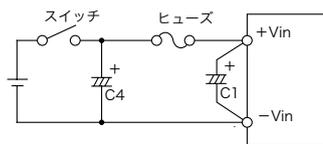
図1-3 スイッチ使用時の入力フィルタ
