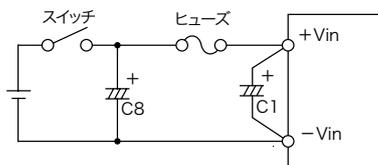
図1-3 スイッチ使用時の入力フィルタ
