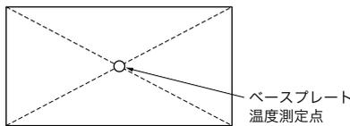
図15-1 ベースプレート温度測定点
