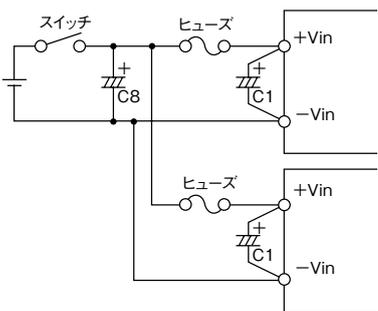
図1-4 複数台接続時の入力フィルタ
