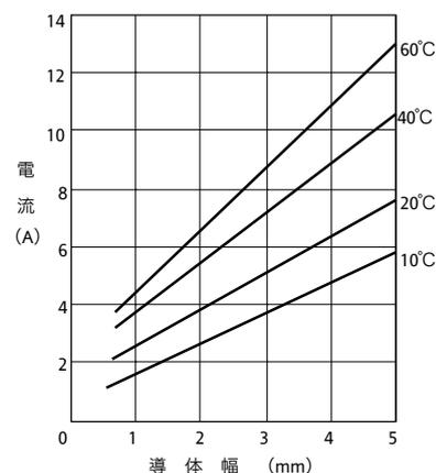
図1-2 銅箔厚35μmにおける許容電流対導体幅特性
