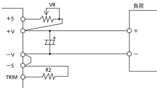
図2-2 外付け抵抗の接続例
