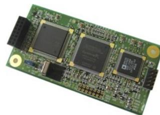
**遠隔操作用 イーサネット・コントローラー - ARL2300**：AR6000を LAN回線を通じ遠隔操作する装置です。Java2 プラットフォームがインストールされたPCで遠隔操作が可能です。ADSL回線(上り) 1Mbps 以上にて外部ネットワークよりルーターを超えて直接アクセスが可能です。15x13x3.5cmの小型の筐体に収納され、電源はAR6000の本体より供給されます。本体との接続は制御用ケーブルと音声信号伝送用ケーブルのみです。
