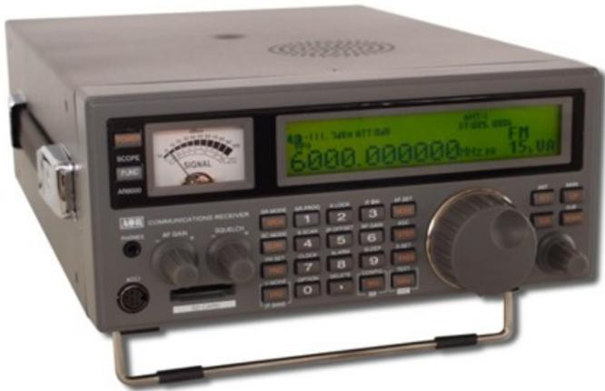
**ゼロIF方式**：AR6000は25MHz以下の処理で採用されたダイレクト・コンバージョン方式と同様に 25MHz以上の受信周波数においても IF信号と同じ周波数あるいは非常に近い周波数を局部発振器(ローカルOSC)で作成IF信号と混合することで信号を処理する“ゼロ IF”方式を採用しています。この方式はイメージ特性に優れているのみならず、復調処理のデジタル化、外部へ I/Q信号を出力するための回路方式です。
