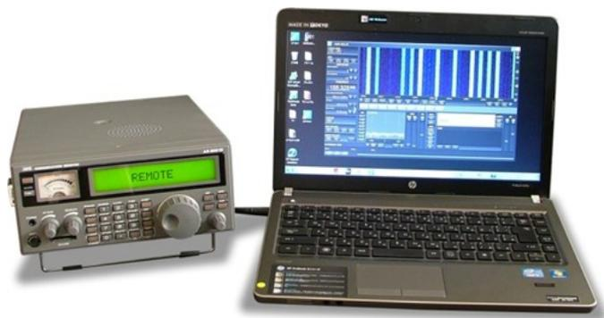
**PC制御ソフトウェア**：AR6000にはWindows PC上で動作する専用の制御ソフトが付属します。スペクトラム、スペクトログラム(ウォーターフォール)の各表示、メモリーマネージメント、アクティビティロギング、チャンネルヒットカウント、自動メモリーなどと従来の受信機では実現できなかった多彩な機能を備えています。制御はUSBポートを通じて行われ、1台のPCで複数台のAR6000を同時に制御することが可能です。(注1)
