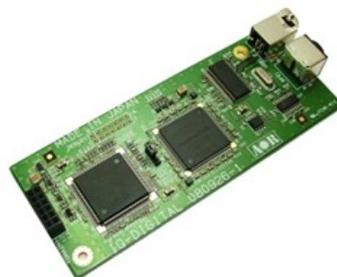
**GPS受信機 - GP5001**：AR6000の周波数精度を0.01ppmへグレードアップするためのGPS受信装置です。AR6000への接続はGPS受信機からのケーブル(約5m)先端のプラグを差し込むだけの簡単な操作です。
