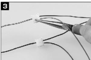
**分岐** LEDをもう一つ接続する場合は、配線コネクターを使用して分岐接続してください。
