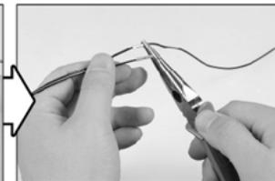
延長したLED側の配線と**1**のプラス・マイナス接続ハーネスを細線圧着接続端子で接続してください
