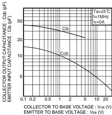
Fig.7 入出力容量 - 電圧特性
