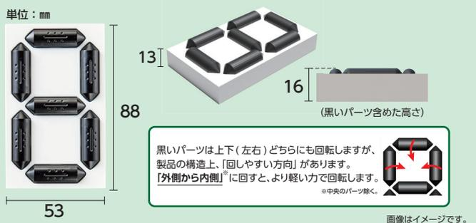
黒いパーツは上下(左右)どちらにも回転しますが、製品の構造上、「回しやすい方向」があります。「外側から内側」に回すと、より軽力で回転します。
