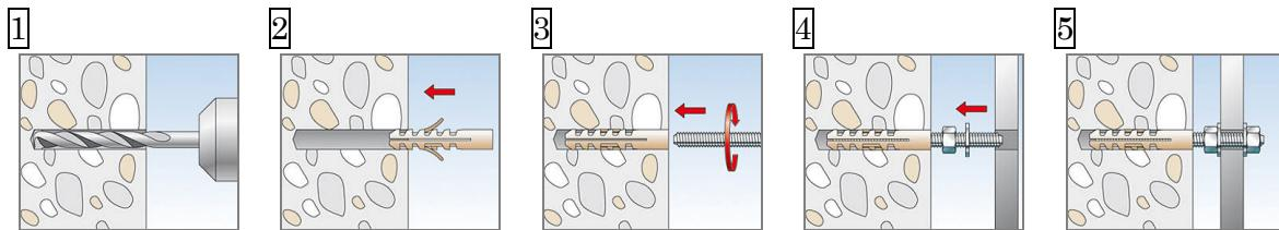
※ レンガ類へは回転のみによる穿孔と取付け。※ 孔内の切粉は除去。
