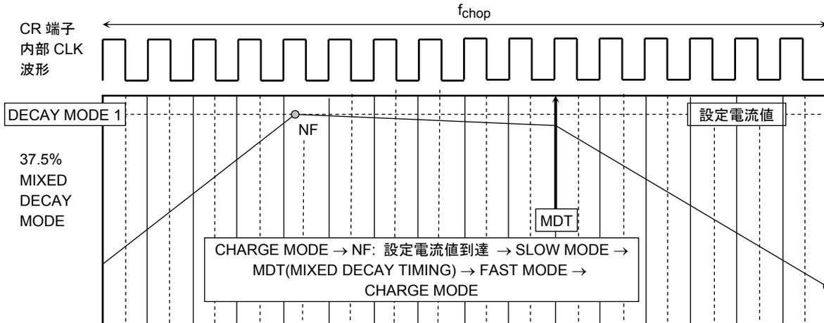
MIXED DECAY MODEの波形（電流波形）
