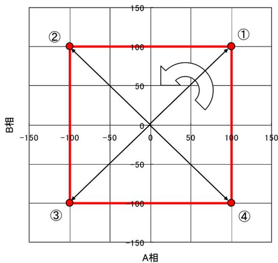
注: 2相励磁は、モータ誘起電力起因の負荷変動が大きい励磁方法です。電流の減衰能力 (電流の制御能力) が小さいモードを使った場合、誘起電力による電流の盛り上がり現象を抑えられない場合があります。
