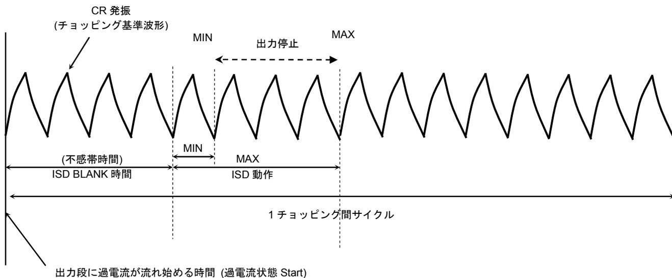
過電流検出回路には、irr やスイッチング時のスパイク電流による誤検出を防ぐために、不感帯時間を設定しています。この不感帯時間は、チョッピング周波数設定用 CR の周波数に同期しており、以下のように設定しています。
