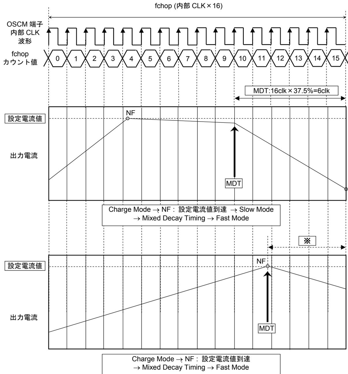
(※)MDTについて: MDTはfchopの37.5%固定となっていますが、出力電流が設定電流値に到達(NF検出)するタイミングによっては、上図のように回生時間がfchopの37.5%以下となる場合があります。このような場合、NF検出と同時にMDT検出し、fchop1周期のうち、残り時間がFast decayとなります。
