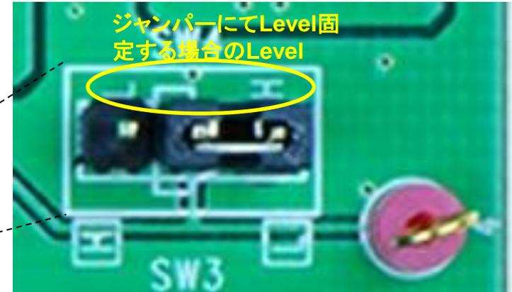
本評価基板には、TB67S261FTGの動作設定を行うための、上図の様なジャンパーを設けております。
