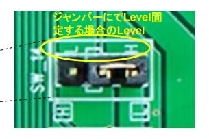
本評価基板には、TB67H400AHGの動作設定を行うための、上図の様なジャンパーを設けております。
