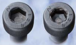
通常のネジ 変形したネジ
