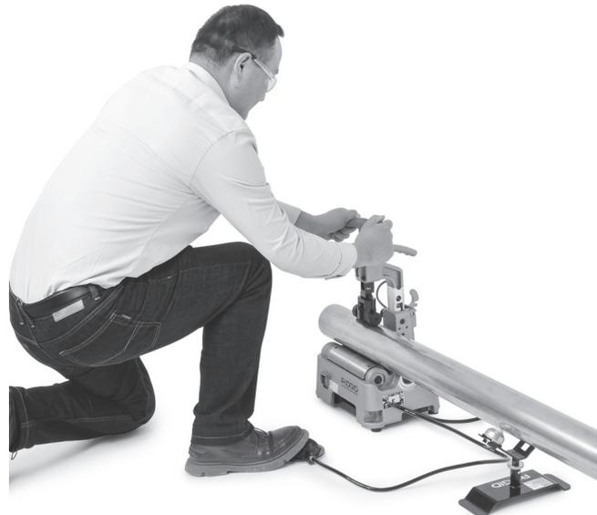
図10-チューブの切断
