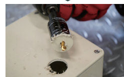
2 切片がホルソーに絡まず落ち、面取りも同時にできます。
