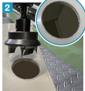
2 切片がホルソーに絡まず落ち、面取りも同時にできます。
